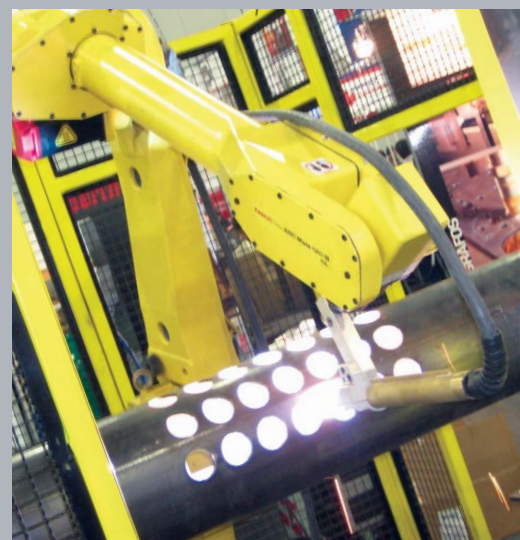
Robotizované 3D řezání
